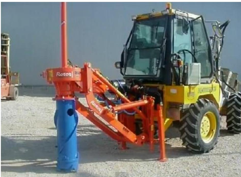
**Rotor Speedy 80/100** является идеальной машиной для выемки пней предварительно сваленных деревьев в парках, на городских улицах, территориях заводов и фабрик. Характерной особенностью данной машины является отсутствие разрушения почвы за пределами рабочего диаметра цилиндра, что особенно важно при работе на перечисленных выше территориях. Кроме того, на освободившееся место сразу можно посадить молодое деревце.
